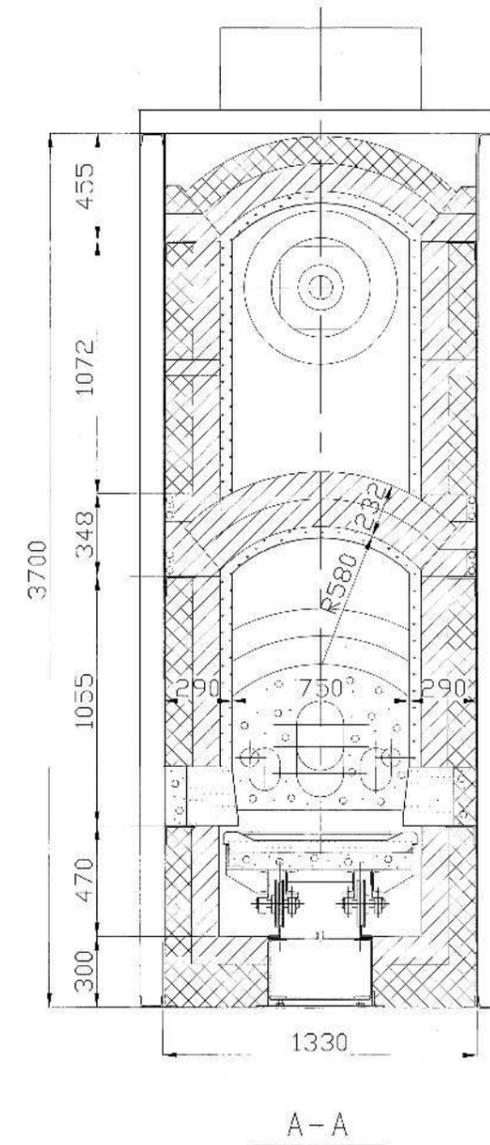
火葬炉耐火物全面積替 ( 号炉)
